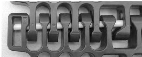
**Figura 315:** Asegurarse de que la varilla pasa más allá del sistema de retención
