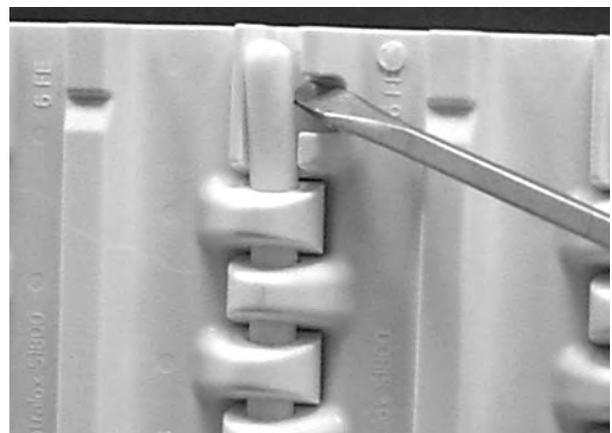
**Figura 206:** Levantar la varilla por encima del sistema de retención
