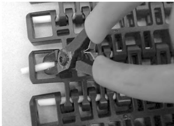
**Figura 357:** Inserte la varilla hasta pasar el sistema de retención
