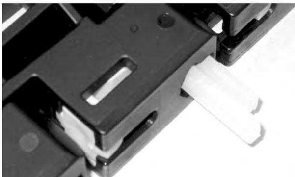
**Figura 185:** Insertar la varilla en las bisagras
