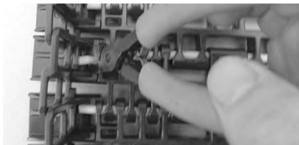
**Figura 367:** Inserte la varilla hasta pasar el sistema de retención
