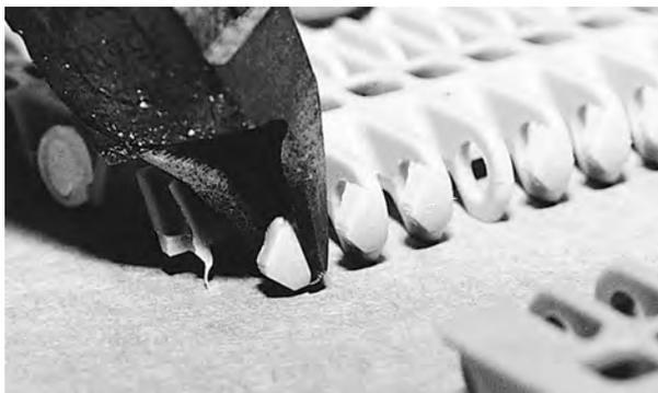
**Figura 27:** Cortar la punta del separador
