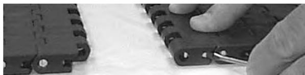
Figura 160: Utilizar un destornillador para cerrar el Slidelox
