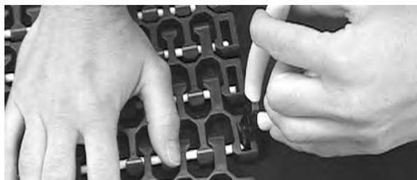
**Figura 309:** Insertar la varilla en la banda
