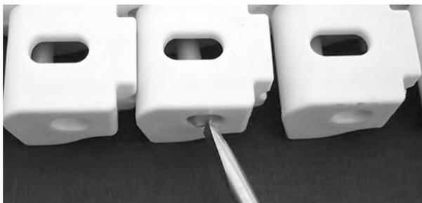
**Figura 283:** Inserte la varilla hasta pasar el sistema de retención
