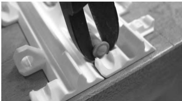
**Figura 182:** Cortar la cabeza de la varilla
