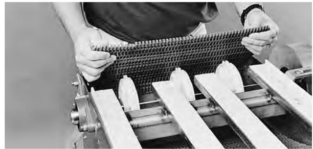
**Figura 11:** Introducir la banda por el recorrido de retorno
