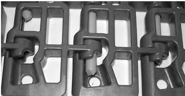
**Figura 124:** Asegurarse de que la varilla esté totalmente introducida
