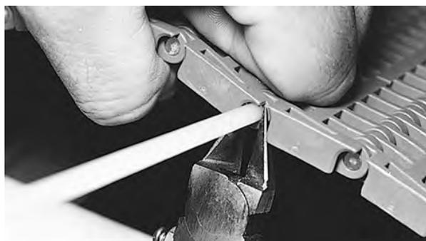
**Figura 113:** Cortar la varilla al ras con el borde de la banda
