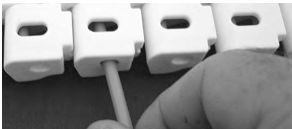
**Figura 282:** Insertar la varilla en las bisagras
