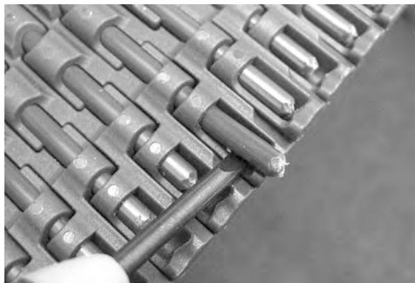
**Figura 56:** Levantar la varilla por encima del sistema de retención
