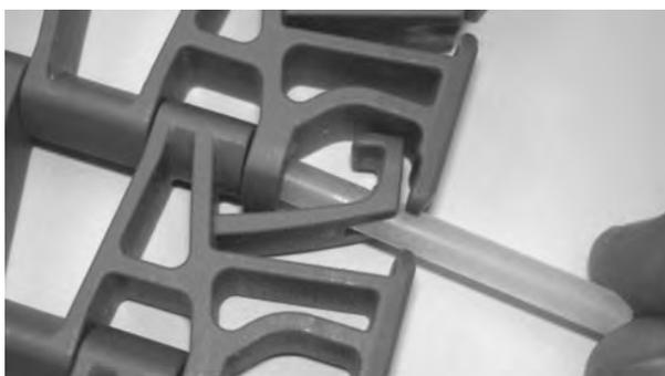
**Figura 246:** Insertar la varilla en las bisagras
