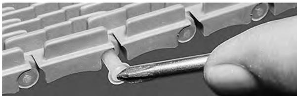
**Figura 22:** Insertar la varilla en la banda
