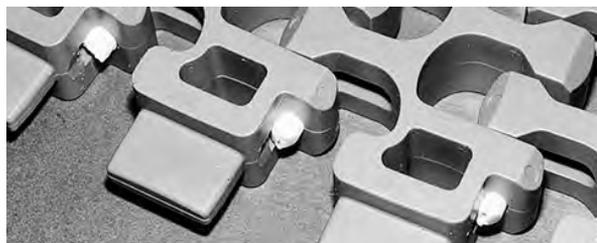
**Figura 272:** Asegurarse de que la varilla esté totalmente introducida
