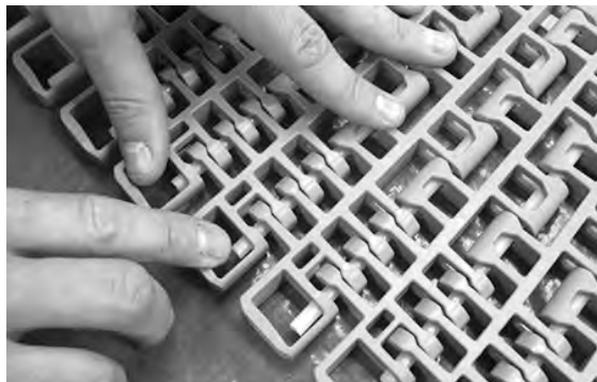
**Figura 339:** Asegurarse de que la varilla pasa más allá del sistema de retención
