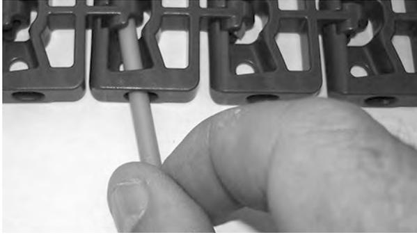
**Figura 122:** Insertar la varilla en las bisagras
