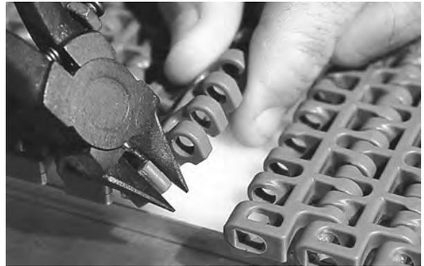
**Figura 142:** Cortar el borde de la banda
