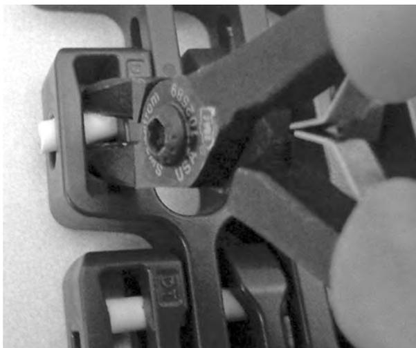
**Figura 316:** Empujar la varilla hacia el costado y más allá del orificio
