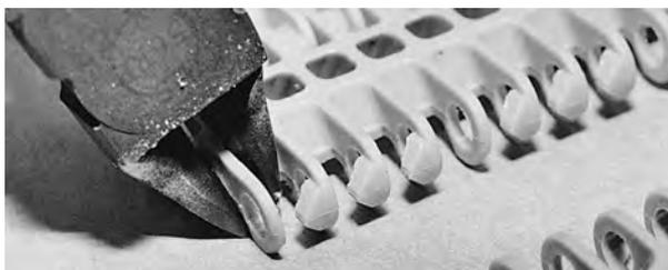
**Figura 26:** Cortar el eslabón más externo
