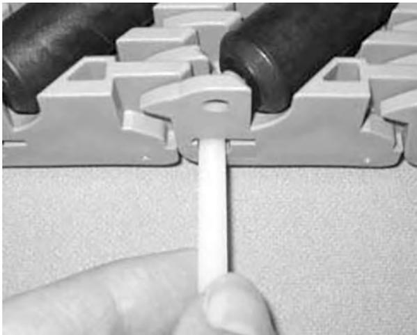
**Figura 230:** Insertar la varilla en las bisagras
