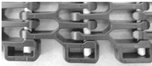
**Figura 326:** Asegurarse de que la varilla esté totalmente introducida
