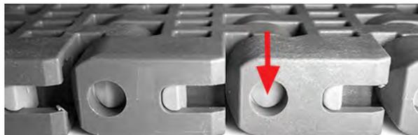
Figura 155: Asegurarse de que el Slidelox está abierto
