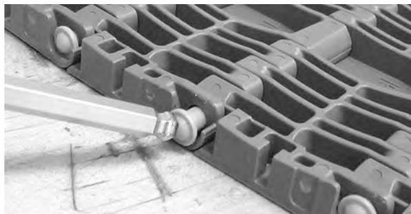
**Figura 267:** Empujar la varillita a través del sistema de retención
