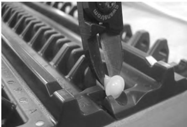
**Figura 71:** Cortar la cabeza de la varilla
