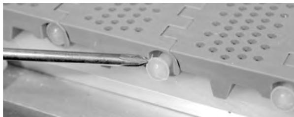
**Figura 63:** Insertar la varilla en la banda
