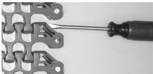
Figura 298: Abrir el sistema de retención
