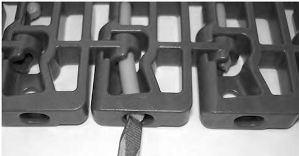
**Figura 123:** Inserte la varilla hasta pasar el sistema de retención
