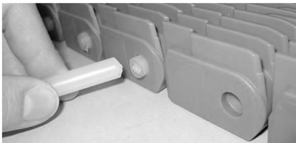
**Figura 216:** Empujar la varilla a través del Shuttleplug
