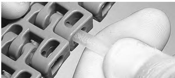
**Figura 135:** Insertar la varilla en las bisagras
