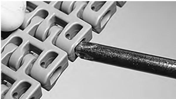
**Figura 145:** Inserte la varilla hasta pasar el sistema de retención
