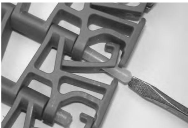
**Figura 247:** Inserte la varilla hasta pasar el sistema de retención
