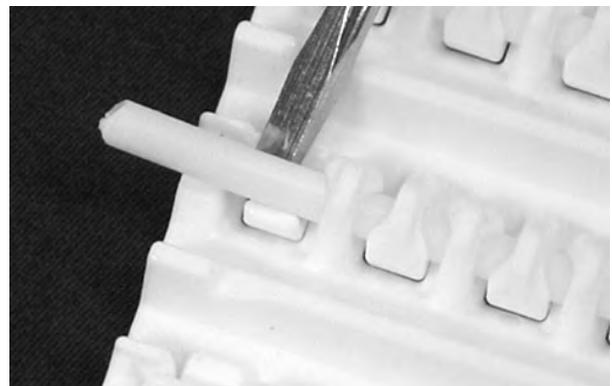
**Figura 176:** Levantar la varilla por encima del sistema de retención
