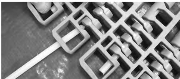
**Figura 337:** Insertar la varilla en las bisagras
