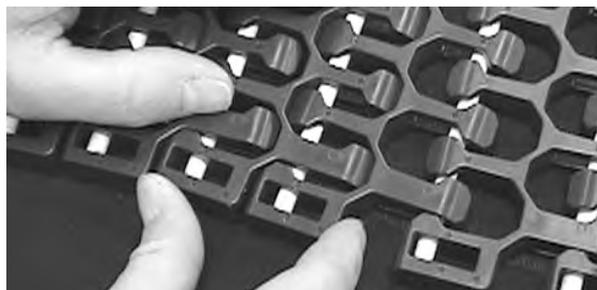
**Figura 308:** Asegurarse de que la varilla esté totalmente introducida
