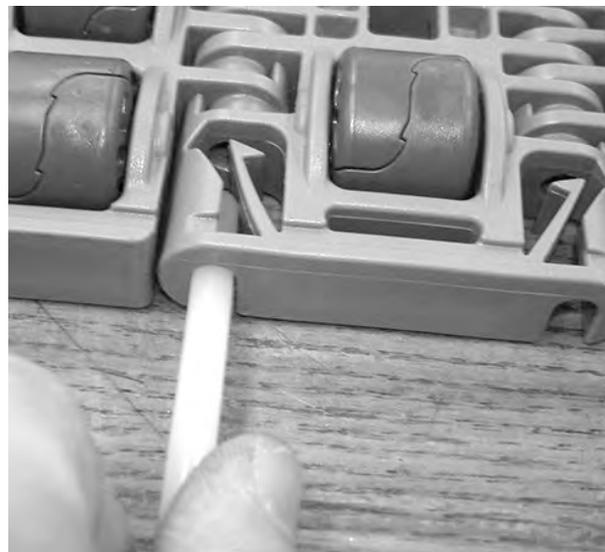
**Figura 220:** Abrir el sistema de retención
