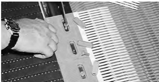
**Figura 18:** Instalar las placas de uñeta de transferencia con pernos de plástico de Intralox
