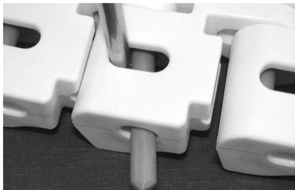
**Figura 285:** Empujar la varilla a través del sistema de retención
