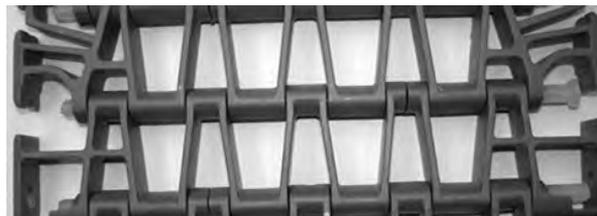
**Figura 255:** Asegurarse de que la varilla pasa más allá del sistema de retención
