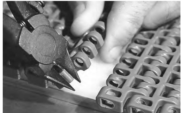
**Figura 152:** Cortar el borde de la banda
