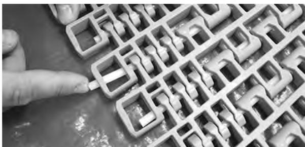
**Figura 338:** Inserte la varilla hasta pasar el sistema de retención
