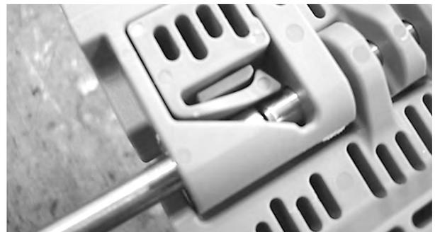
**Figura 104:** Inserte la varilla hasta pasar el sistema de retención
