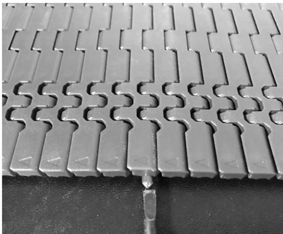
**Figura 59:** Introduzca la varilla hasta rebasar el sistema de retención
