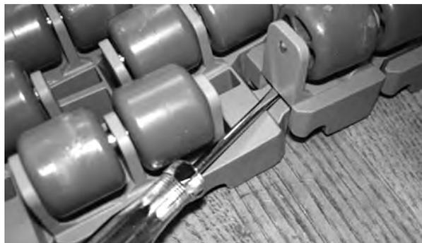
Figura 192: Introducir el destornillador bajo el rodillo
