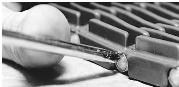
**Figura 112:** Asegurarse de que la varilla pase más allá del cierre a presión
