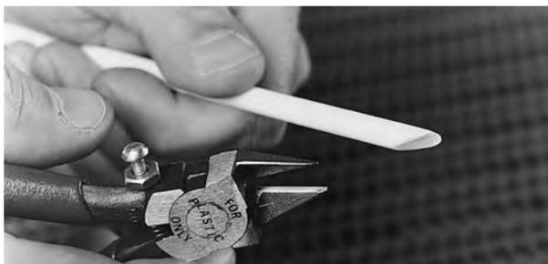
**Figura 14:** Recortar la varilla en ángulo
