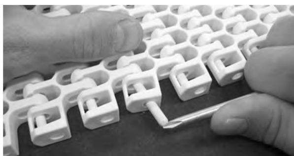
**Figura 288:** Inserte la varilla hasta pasar el sistema de retención
