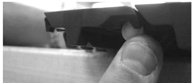
**Figura 69:** Inserte la varilla hasta pasar el sistema de retención
