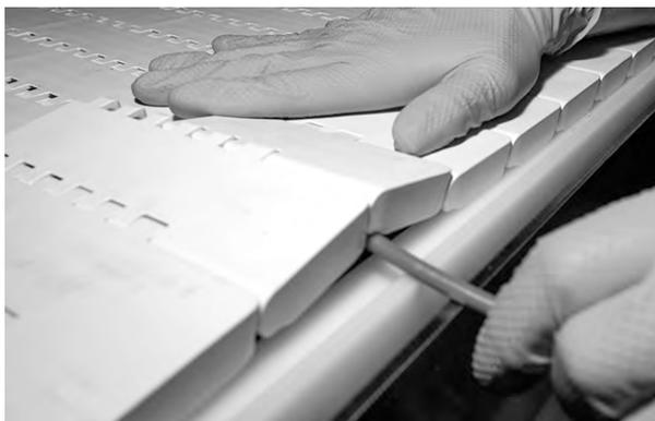
**Figura 88:** Doblar ligeramente e insertar la varilla en las bisagras
