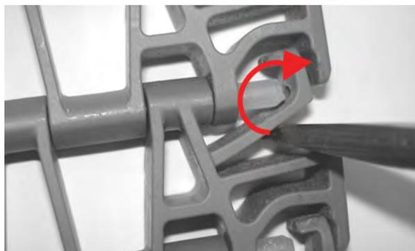
**Figura 249:** Girar el destornillador para mantener abierto el sistema de retención
