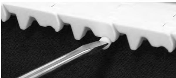
**Figura 174:** Inserte la varilla hasta pasar el sistema de retención
