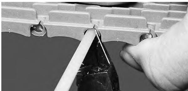
**Figura 24:** Cortar la varilla al ras con el borde de la banda
