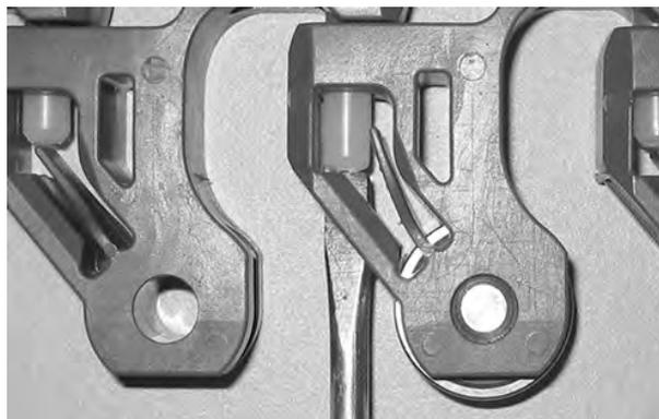
Figura 278: Inserte la varilla hasta pasar el sistema de retención
