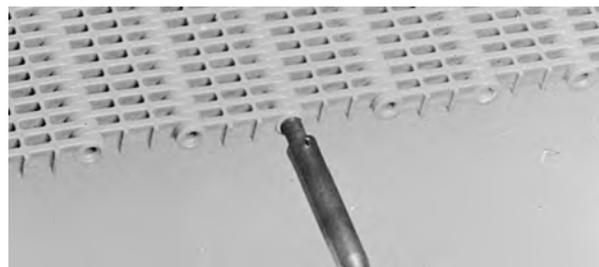
**Figura 30:** Cerrar el orificio de la varilla
