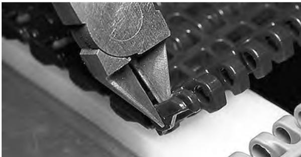
**Figura 150:** Cortar el elemento de borde
