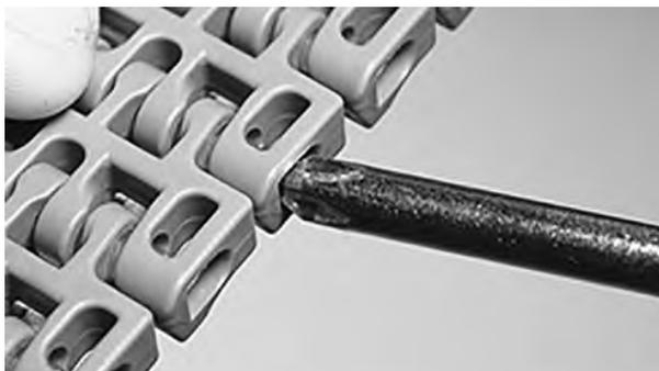
**Figura 136:** Inserte la varilla hasta pasar el sistema de retención
