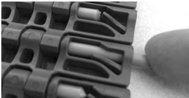
**Figura 127:** Insertar la varilla en las bisagras
