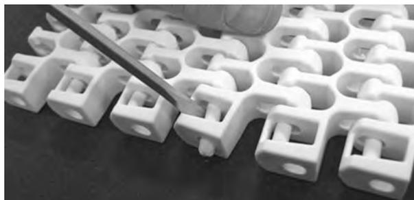
**Figura 290:** Empujar la varilla a través del sistema de retención
