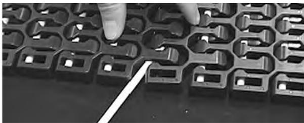
**Figura 304:** Insertar la varilla en las bisagras
