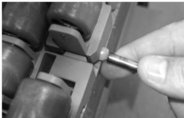
Figura 190: Inserte la varilla hasta pasar el sistema de retención
