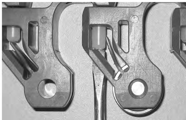
Figura 300: Inserte la varilla hasta pasar el sistema de retención
