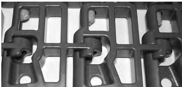
**Figura 116:** Las varillas se adentran en el borde al ras
