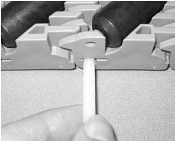
**Figura 224:** Insertar la varilla en las bisagras
