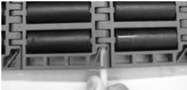
**Figura 236:** Insertar la varilla en las bisagras
