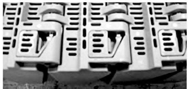
**Figura 105:** Asegurarse de que el sistema de retención está cerrado
