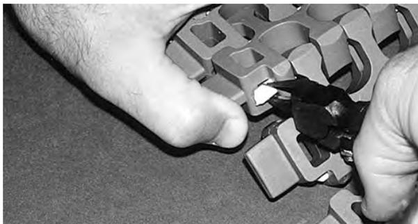
**Figura 273:** Soltar la varilla del sistema de retención
