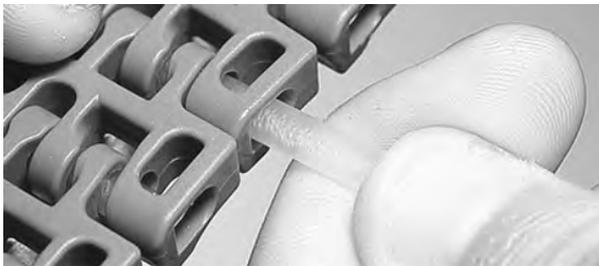
**Figura 144:** Insertar la varilla en las bisagras
