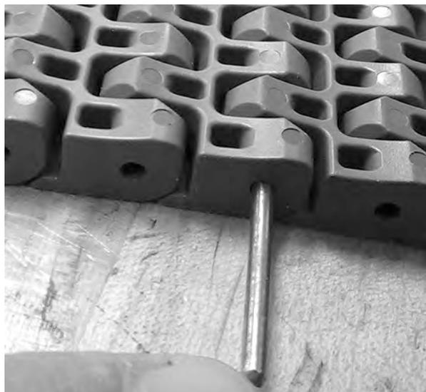
**Figura 269:** Sacar la varilla y la varillita de la banda
