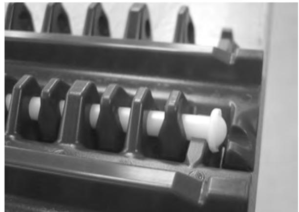
**Figura 99:** Asegurarse de que la varilla pasa más allá del sistema de retención
