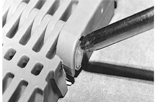
**Figura 48:** Empujar la varilla a través del sistema de retención
