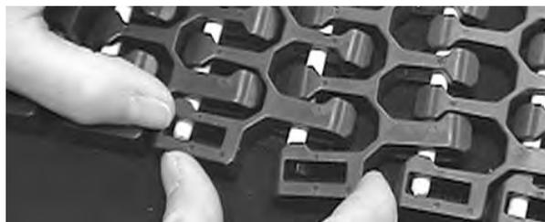
**Figura 307:** Empujar la varilla hasta que pase más allá del borde de la banda y enganchar a presión el borde al ras por encima de la varilla
