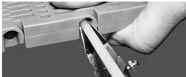
**Figura 39:** Cortar la varilla al ras con el borde de la banda
